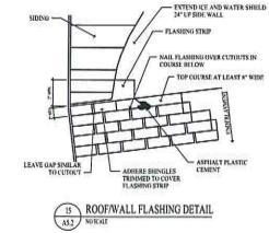
RAKE WALL FLASHING DETAIL
